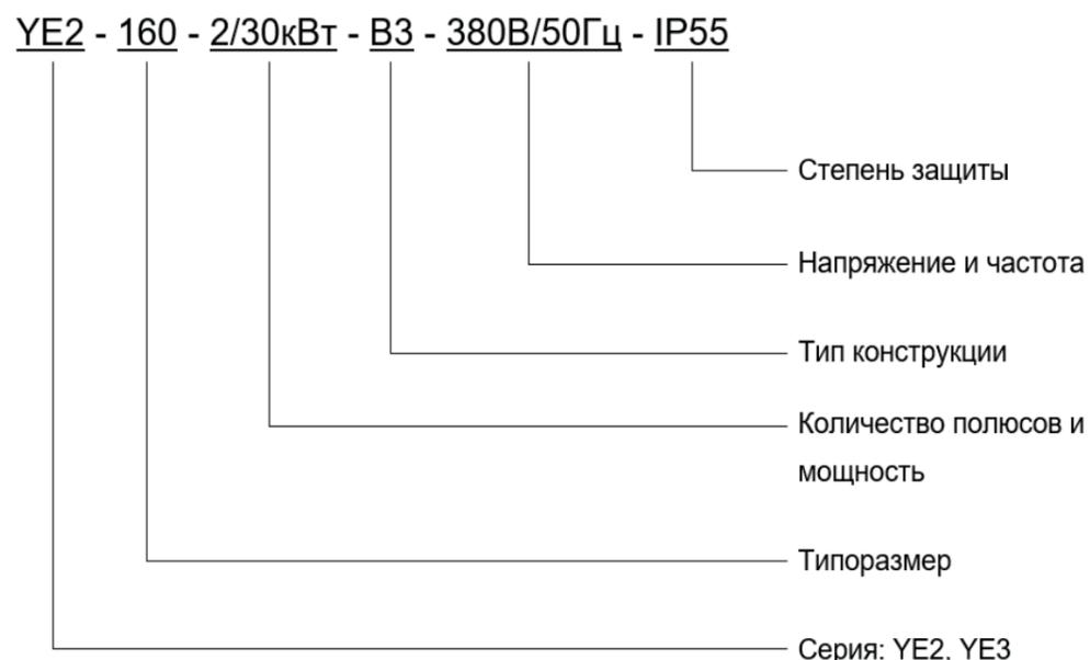
Электродвигатели серии YE2, YE3 с высокой эффективностью и переменной частотой вращения выгодно отличаются структурой и методом охлаждения. Электродвигатели данной серий обладают превосходными электромеханическими характеристиками, имеют высокую надежность, производительность.
