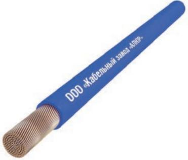
Провод одножильный с гибкой медной жилой, с изоляцией из поливинилхлоридного пластика пониженной пожарной опасности, без оболочки, не распространяющий горение, с низким дымо- и газовыделением. | ГОСТ 31947-2012<br>ТУ 16-705.502-2011 |
