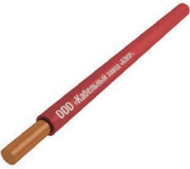
Провод одножильный с медной жилой, с изоляцией из поливинилхлоридного пластика пониженной пожарной опасности, без оболочки, не распространяющий горение, с низким дымо- и газовыделением.         | ГОСТ 31947-2012<br>ТУ 16-705.502-2011 |
